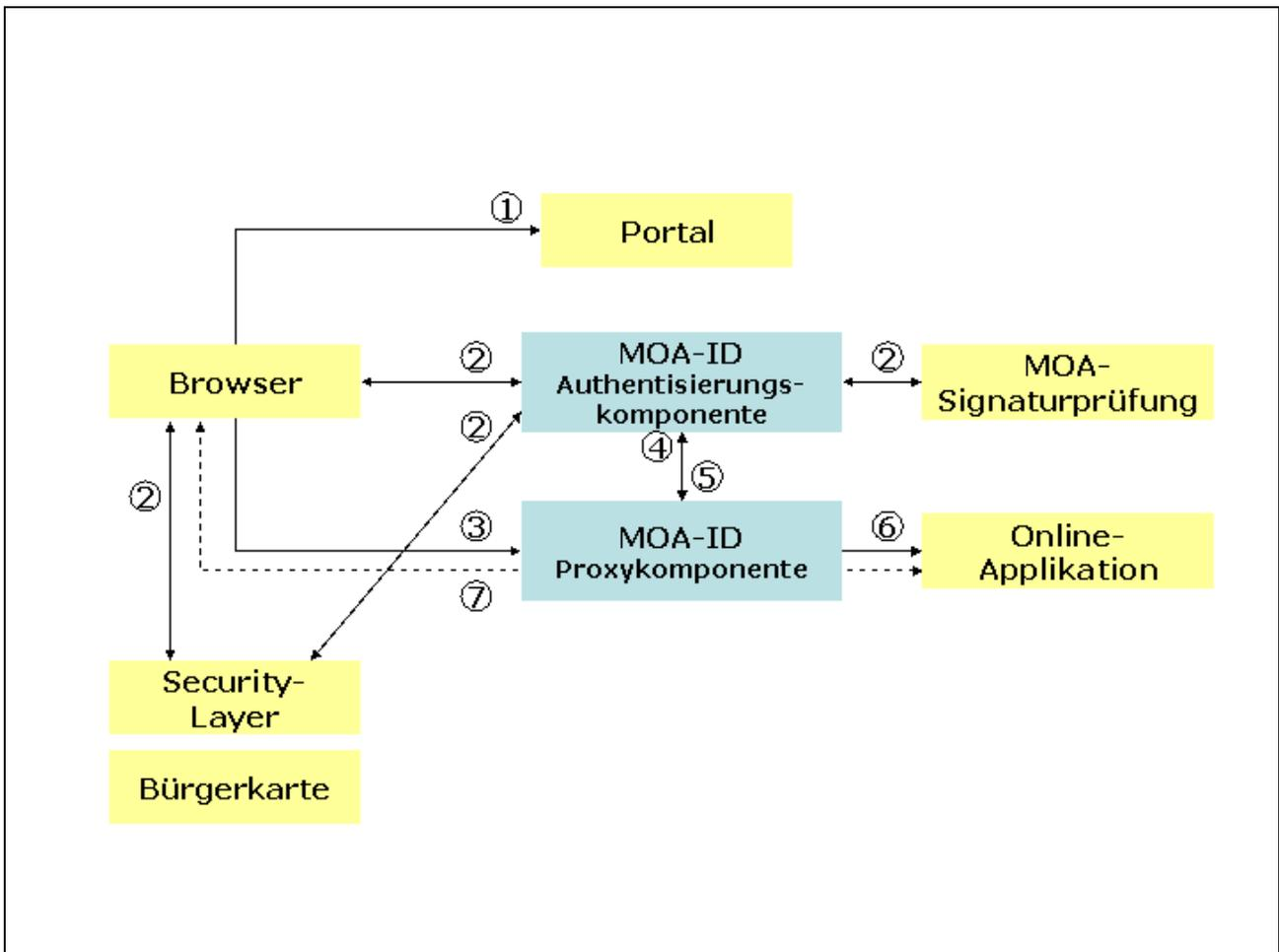
MOA-ID besteht aus zwei Komponenten, der Authentisierungskomponente und der Proxykomponente, die mit dem Browser des Benutzers und Online-Applikationen Schnittstellen aufweisen. Mit dem Security-Layer des Benutzers wird sowohl über den Browser als auch direkt kommuniziert.
